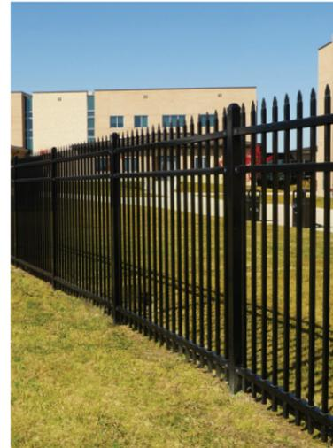
**Piquets verticaux allongés** Traverse : 1,75 po [44 mm] x 1,75 po [44 mm] (14 ga) | Piquet vertical : 34 po à 70 po [864 mm à 1 778 mm] (16 ga), 82 po et 94 po [2 083 mm et 2 388 mm] (14 ga) | Espace libre : 3,9 po [100 mm]
